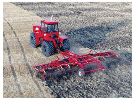
Культиватор Landmaster-8500 в работе с трактором Т-360
